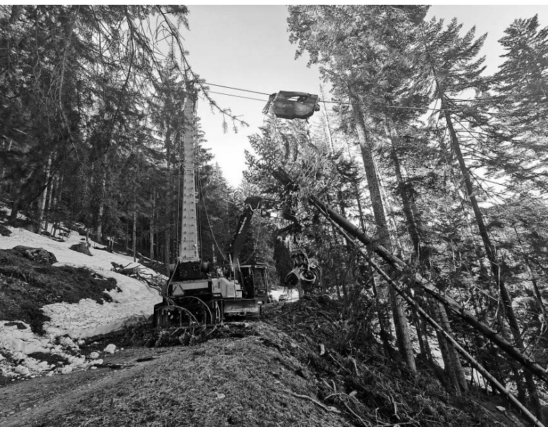
Holztransport mit dem Mobilseilkran am Muttahang.
